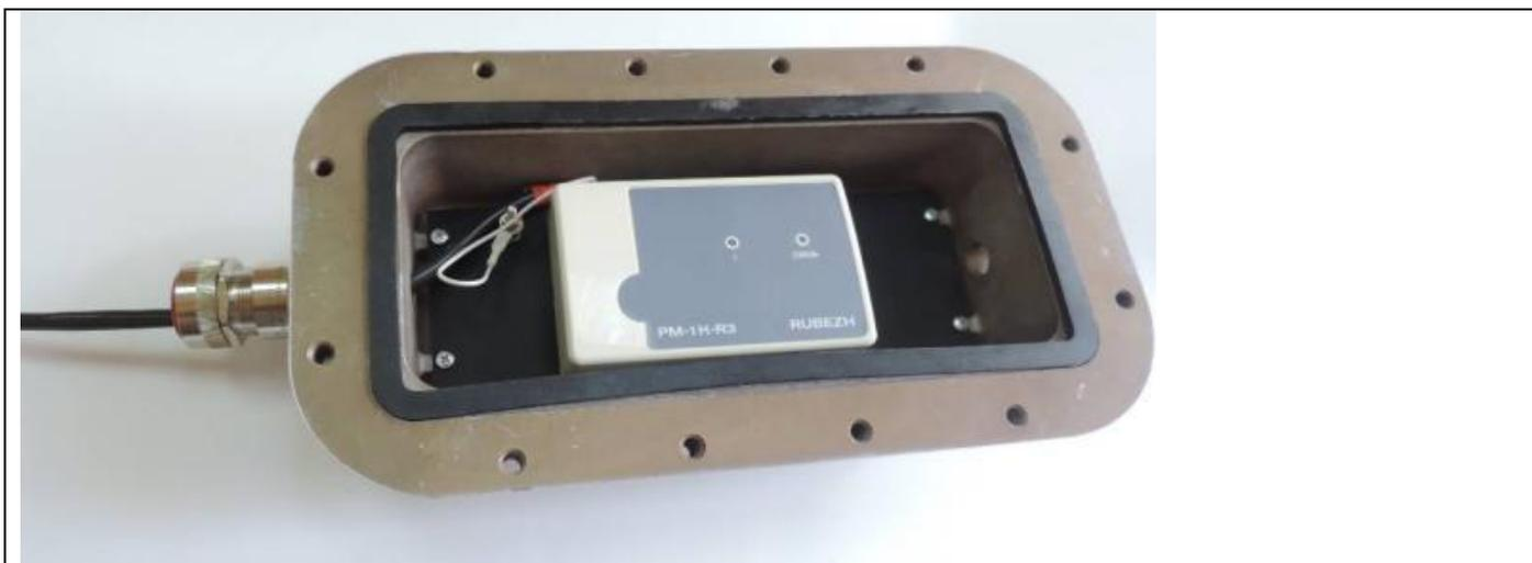
Рисунок Е.11 – Модуль (с крышкой) на пластине установлен в корпус. Кабельный ввод закручен.
