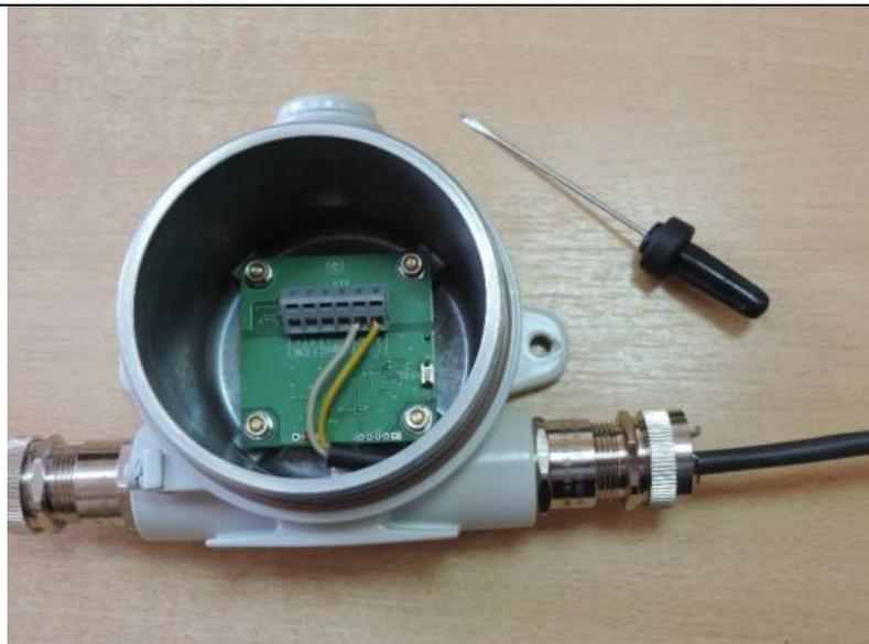
Рисунок Г.3 – Коробка ККВ14 с кабелем (кабель показан для примера)
