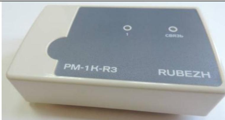
Снять крышку с модуля PM-1K-R3
